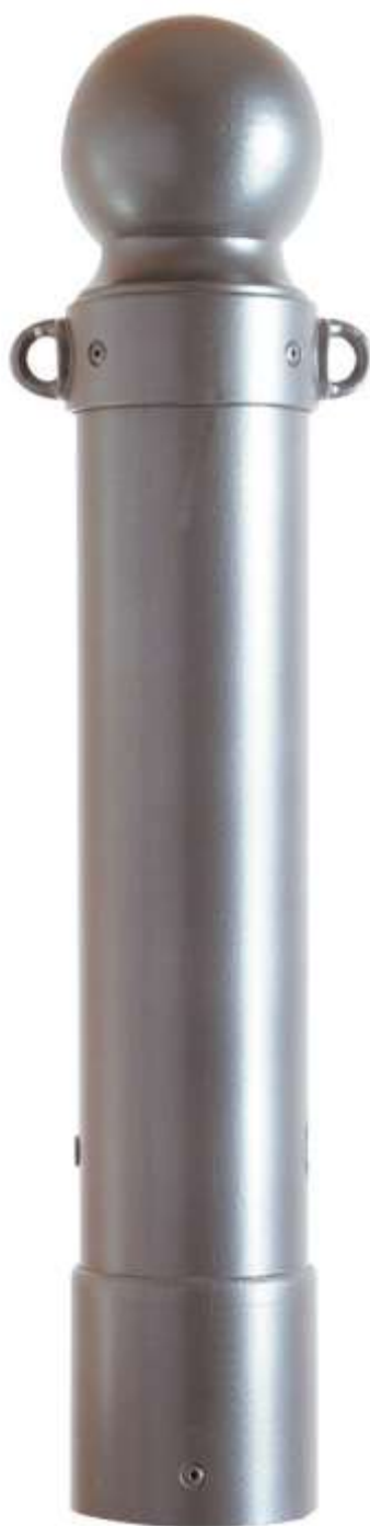
Karštai cinkuotas vamzdis d140mm , h950mm Stacionarus, įbetonuojamas, bendras ilgis 1400 mm Išimamas, su trikampių rakinimo mechanizmu, su įbetuojama karštai cinkuota gilze, įleidžiama apie 500 mm
