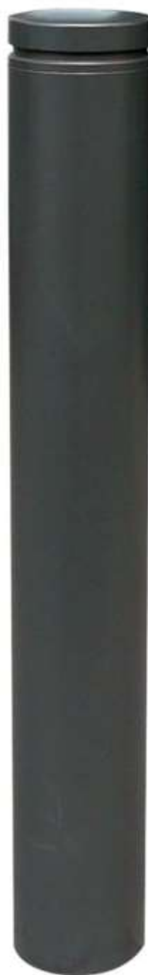
Karštai cinkuotas vamzdis d100 mm, d120mm, d150 mm, h950mm, su aliumine galvute Stacionarus, įbetonuojamas, bendras ilgis 1400 mm Išimamas, su trikampių rakinimo mechanizmu, su įbetuojama karštai cinkuota gilze, įleidžiama apie 500 mm
